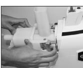
4. Разблокируйте обе защелки, потянув за металлические пластиинки. Отодвиньте защелки от камеры для выхода сока.
