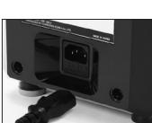
8. Подсоедините кабель питания к задней части устройства, вилку на другой стороне кабеля – в электрическую розетку.
