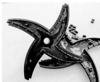
**Разбрызгиватель был разобран на 2 части для очистки. Остатки семян могли забиться в мелкие отверстия для воды**
